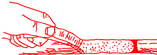
图 2.5.2 硅酮结构胶现场手拉试验示意
